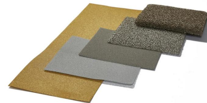
Na prática, a adoção da espuma de níquel permite uma redução da tensão de operação nos eletrolisadores alcalinos, principal fator de custo do hidrogênio verde.
